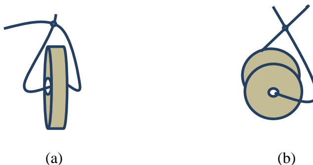
Figura 1.4 - Desenhos ilustrativos de como utilizar o fio de algodão ou de nylon como um suporte para massas: (a) uma única massa e em (b) visão frontal de mais de uma massa (no caso duas massas). FONTE: o autor.
